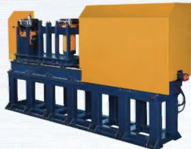
採用服馬達高精度滑軌定位式與立柱分離可獨立穩固於地面
